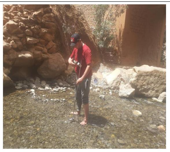
**Figure 5.** Point de jaugeage par Micro-Moulinet (OUZANNI 2022)
